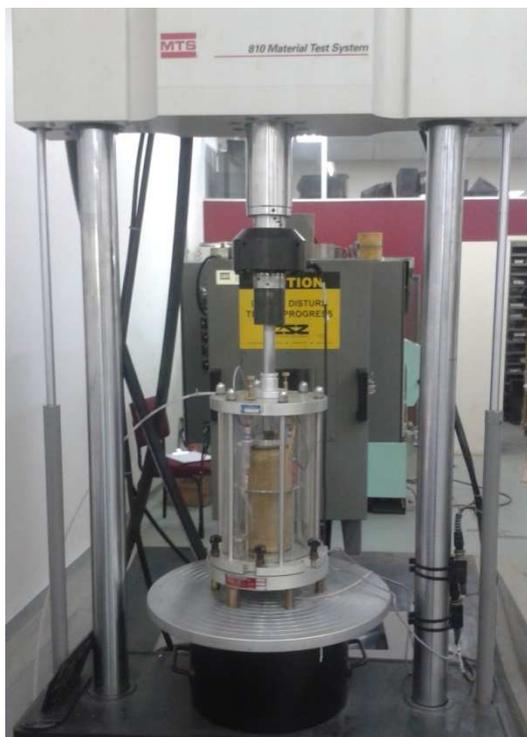
**Figura 31 – Ensaio de deformação permanente conduzido na MTS (*Material Test System*)**
