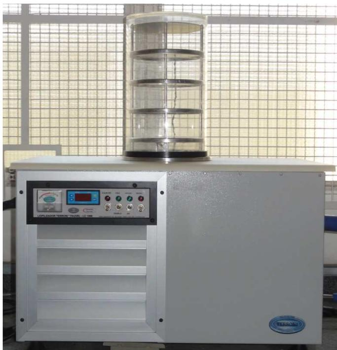
**Figura 20 – Liofilizador utilizado para liofilização das pastas estudadas**
