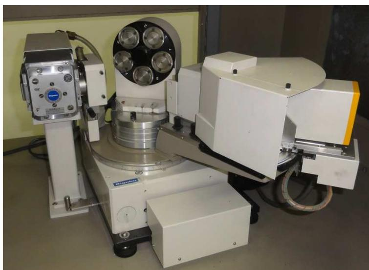
**Figura 15 – Difratômetro-utilizado nos ensaios de difração de raios X**
