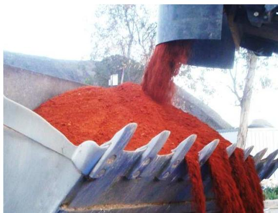
**Figura 8 – Aspecto do agregado reciclado de tijolo cerâmico**
