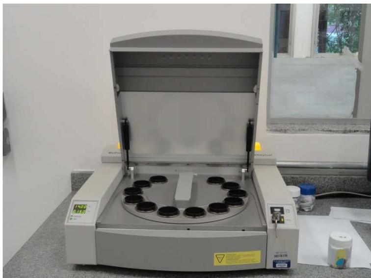
Figura 14 – Equipamento utilizado nos ensaios de FRX
