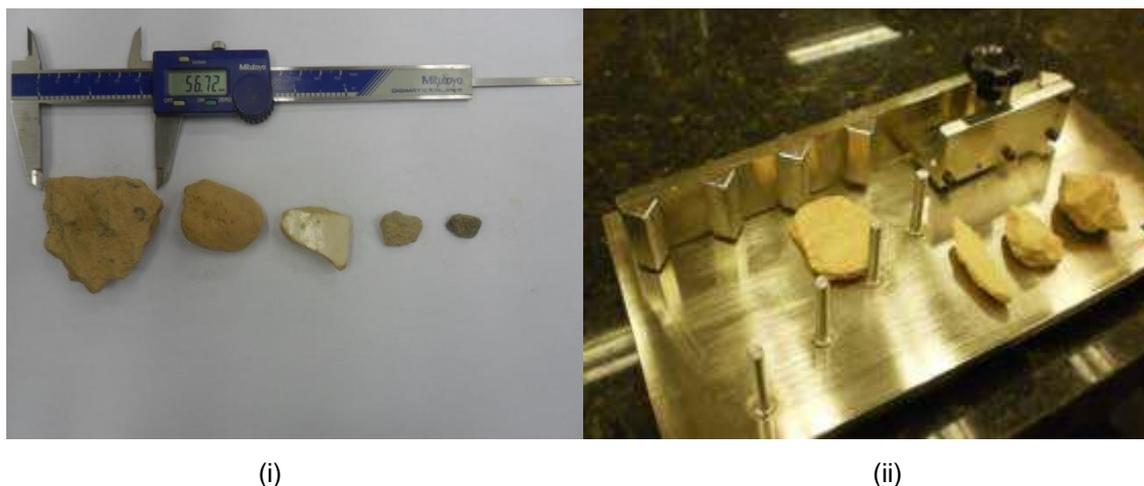
Figura 3.7– Equipamentos em laboratório para determinação da formados agregados: (i) segundo NBR 7809 (ABNT, 2006), (ii) segundo D4791 (ASTM, 2010).
