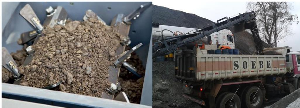
Figura 4.3 – Pugmill e esteiras de distribuição de material reciclado em usina recicladora
