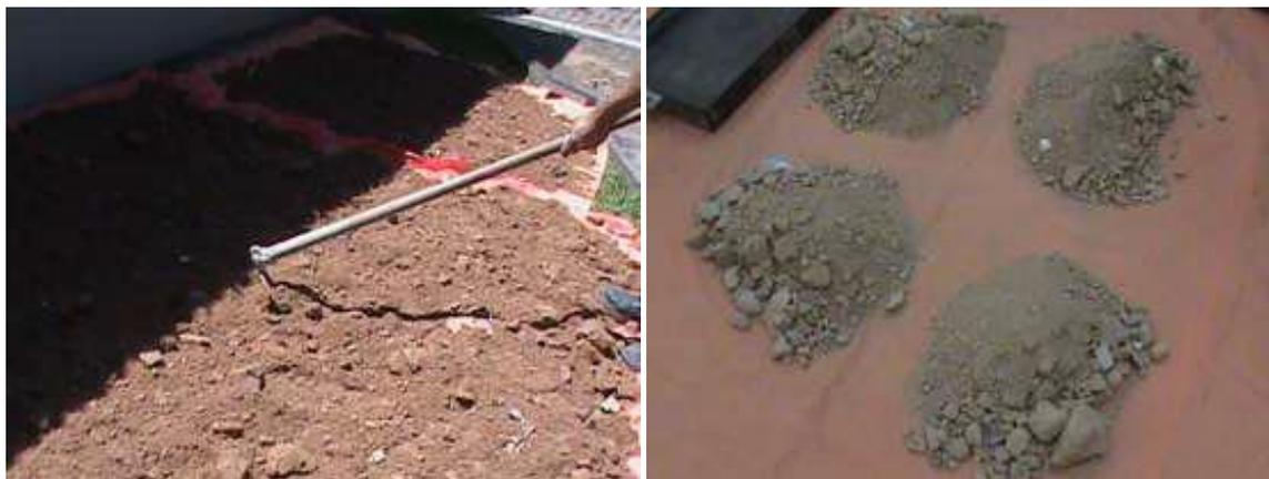
Figura 3.5 – Agregado reciclado espalhado para fins de secagem ao ar e quarteamento
