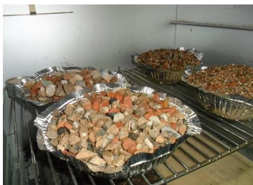
Figura 5.2 – Secagem em estufa até constância da massa após lavagem
