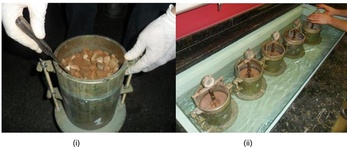
Figura 3.10 – Determinação do CBR: (i) preparo das amostras dentro do cilindro CBR; (ii) amostras imersas em água para verificação da expansão
