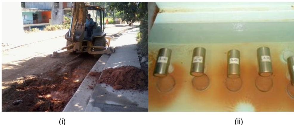
Figura 4.4 – (i) coleta do material de subleito, e (ii) ensaio de perda por imersão do procedimento MCT
