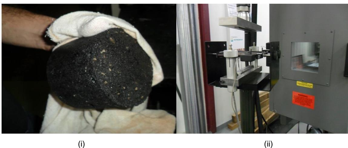
Figura 6.6 – (i) amostra compactada em laboratório, e (ii) instrumentação para ensaio de módulo de resiliência em mistura asfáltica
