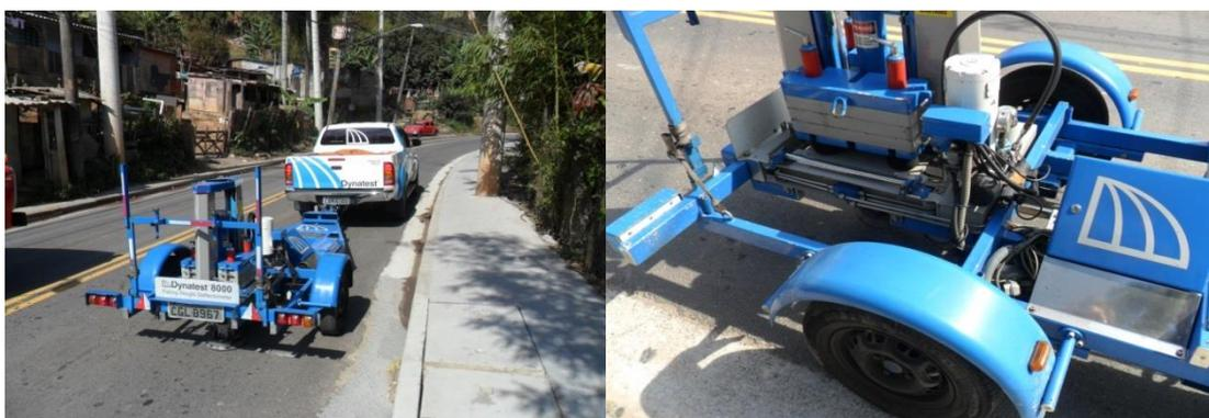
Figura 6.8 – Medida de deflexão no eixo e na trilha externa da via
