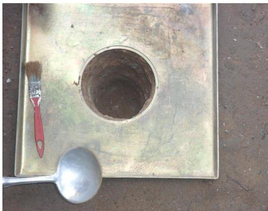
Figura 6.3 – Execução do furo de interesse e determinação da umidade pelo método do fogareiro
