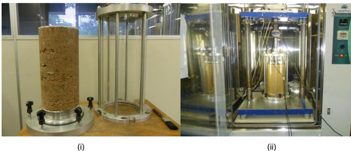
Figura 5.7 – (i) vista do corpo de prova compactado, e (ii) instrumentação para ensaio triaxial conforme ME 134 (DNIT, 2010)
