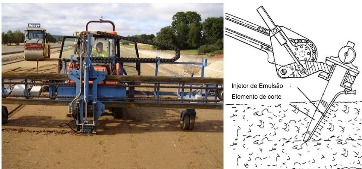
Figura 2.7 – Equipamento para indução de trincas (AGRELA *et al.*, 2011)
