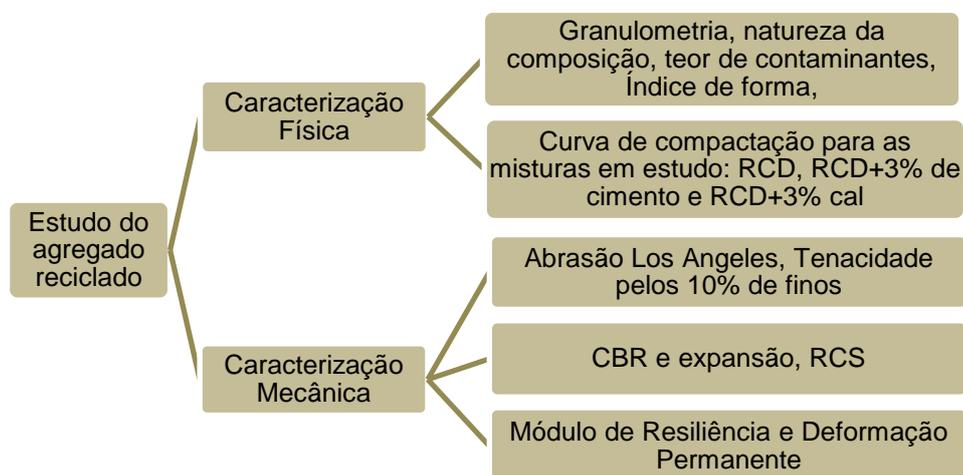
Figura 3.1 – Fluxograma do estudo de comportamento do material em laboratório
