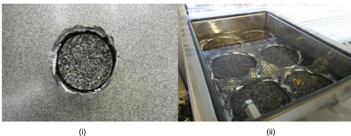
Figura 6.4 – (i) aspecto das amostras compactadas, e (ii) imersão em água durante o período de 24 horas para posterior ruptura
