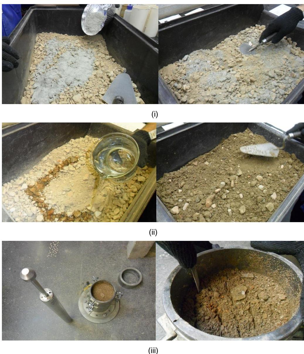
Figura 3.12 – Processo de dosagem e preparo de corpos de prova para ensaios de módulo de resiliência: (i) homogeneização com o aglomerante a seco, (ii) mistura e homogeneização com água potável, e (iii) compactação com cilindro tripartido e controle de camadas
