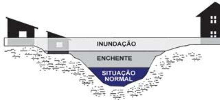
Figura 2.1: Perfil esquemático representando os processos de enchente e inundação.
