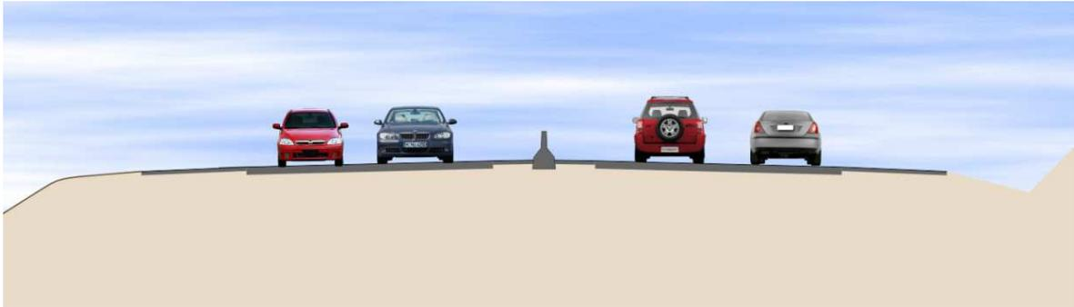
**Figura 3.27 - Seção tipo de rodovia com barreira central dupla - trecho em tangente**
