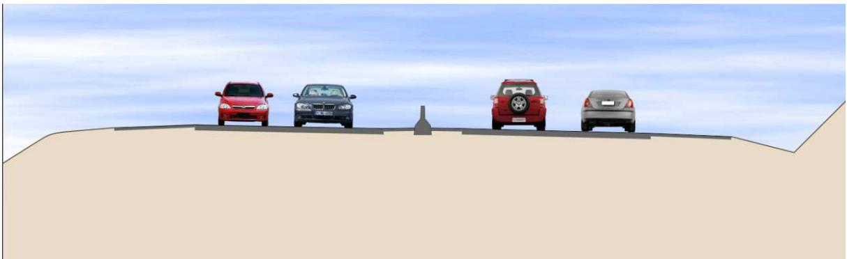
**Figura 3.28- Seção tipo de rodovia com barreira central dupla- trecho em curva**
