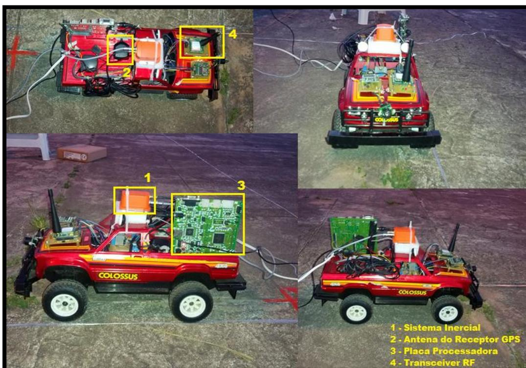
Figura 26 – Detalhe da adaptação da plataforma veicular e demais sensores.
