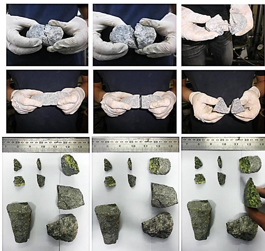
Figura 53 - Agregados deteriorados após os ensaios mecânicos GE I e GE II
