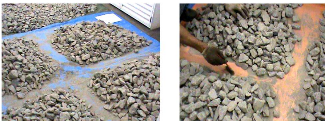
Figura 40 - Homogeneização e quarteamento do material
