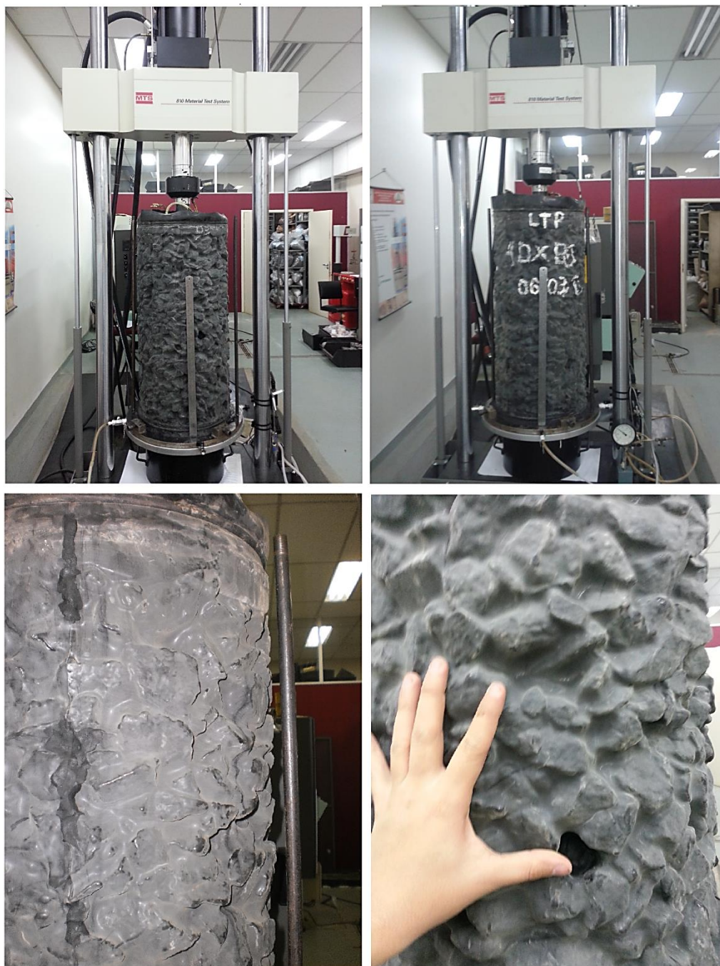
Figura 54 – Detalhe das amostras durante a ciclagem GE I (esquerda) e GE II (direita)
