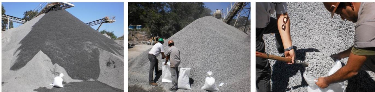
Figura 32 - Detalhe da coleta realizada na pedreira Brasitália
