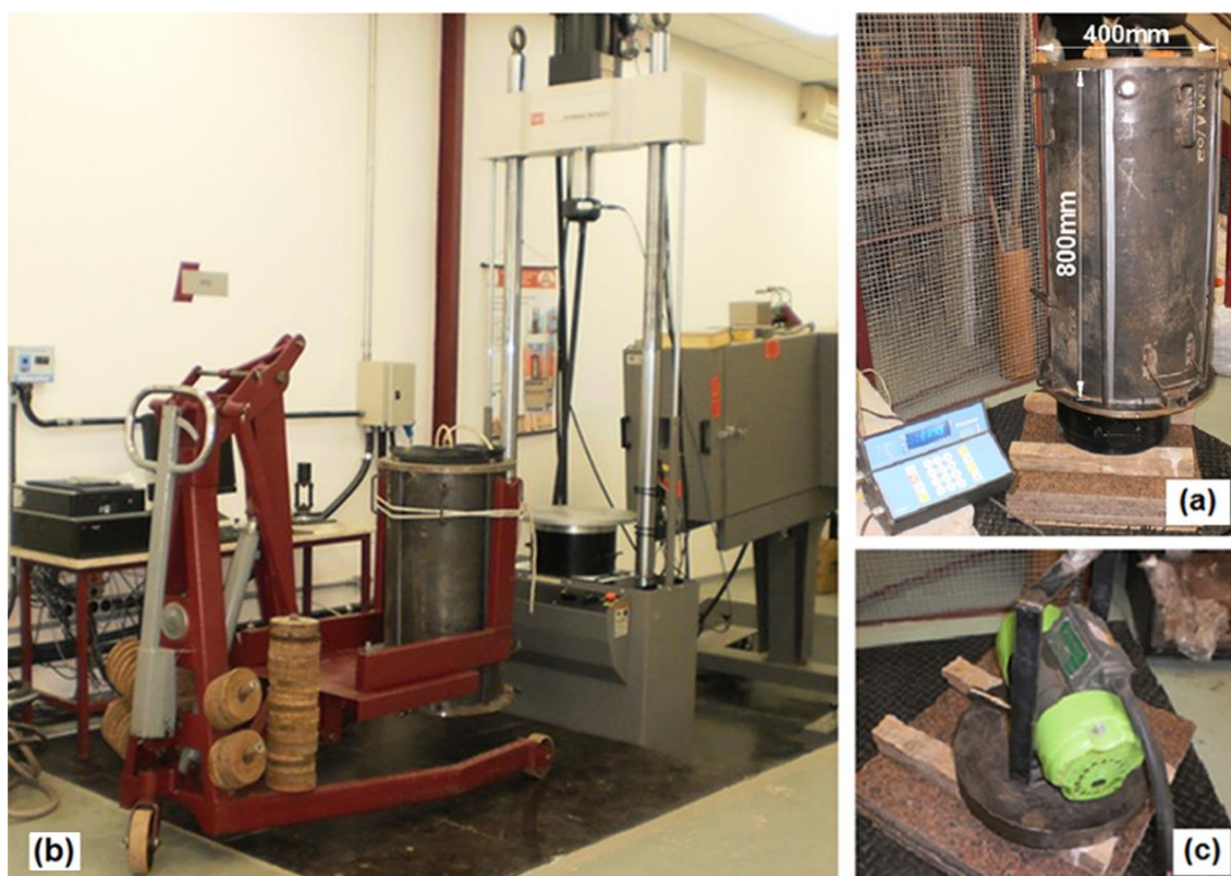
Figura 34 - Aparato triaxial de grande escala no LTP (a) pesagem do molde, (b) grua de transporte e bancada de ensaio, e (c) vibrador elétrico
