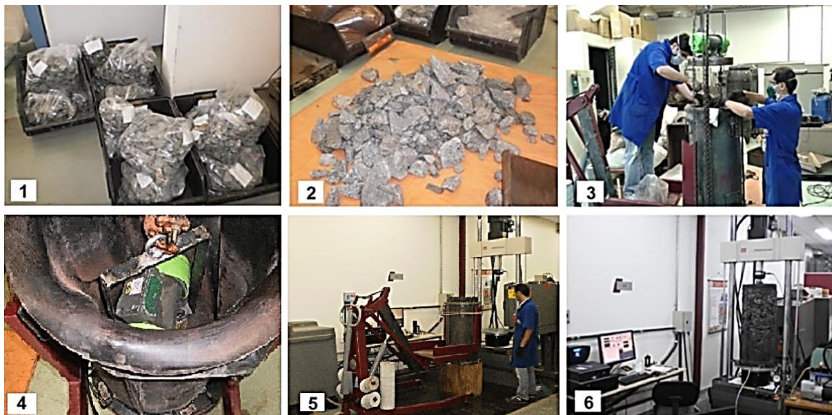
Figura 44 - Etapas de preparação do corpo de prova de grande escala
