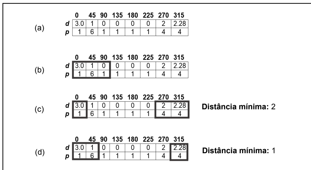
Figura 27: Exemplo de cálculo de distância conjunta em uma Grade de 45° de abertura com Regiões de Agrupamento de três setores circulares
